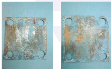
а) пластинки с гальваническим цинковым покрытием
