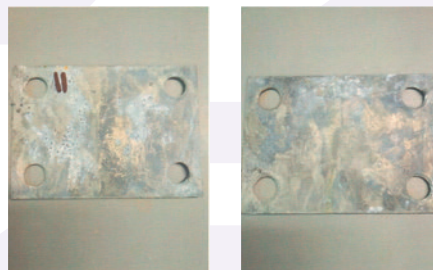
а) пластинки с горячеоцинкованным цинковым покрытием
